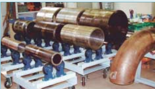
自然模擬欠陥(疲労・SCC)付 UT 研修用試験体
